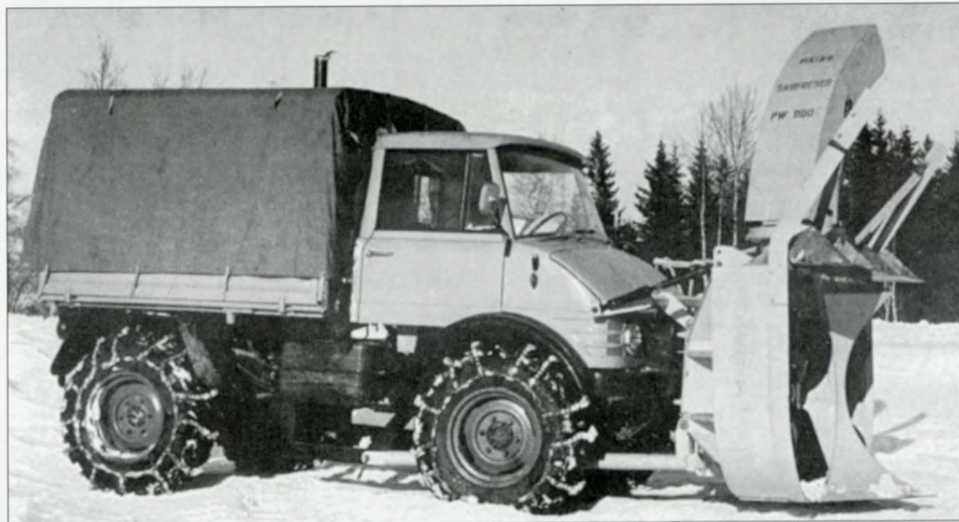
Hjulfres PW 1100 M på Unimog bil. Foto: Øveraasen
